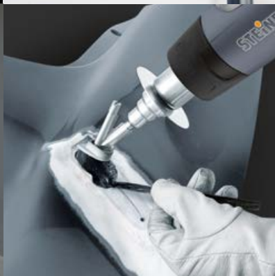
▲ Réparation des pare-chocs HG 2320 E
