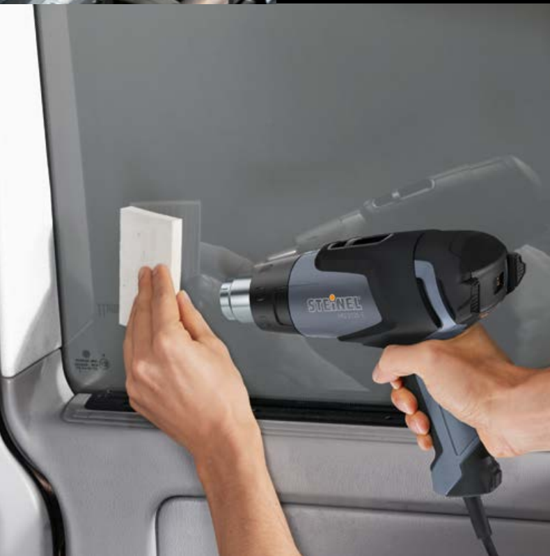
▼ Application d'un film HG 2120 E
