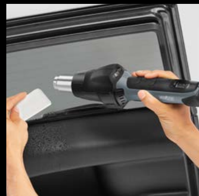
▼ Application d'un film HG 2220 E
